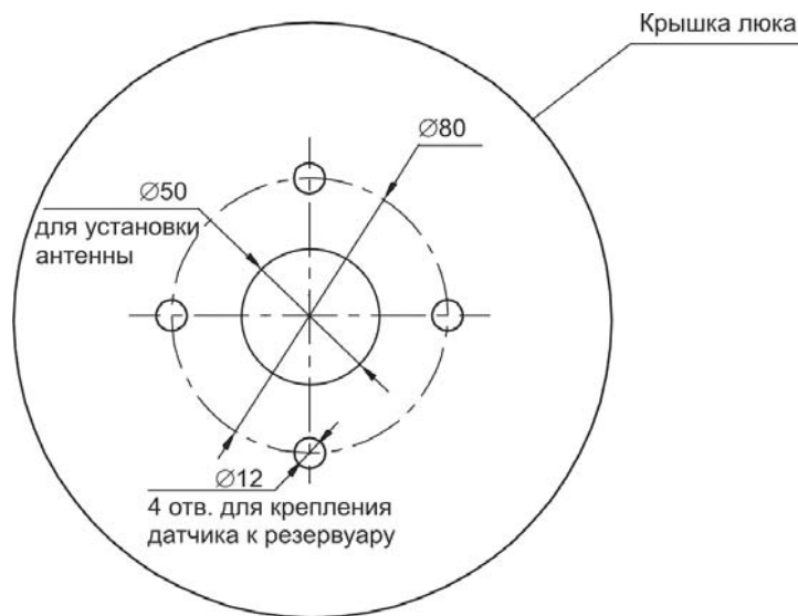
Рисунок 2 – Рекомендуемый вариант посадочного места датчиков РДУ1-0(0А, 1, 1А, 2, 2А), РДУЗ-00(01, 10, 20) на резервуаре
