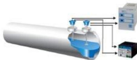
**3.3** Датчики положения уровня ДПУ7 (далее «датчики») изменяют состояние выходного частотного сигнала в зависимости от положения уровня жидкости и результатов самопроверки. Датчики подключаются к ПВС7 (ПВС7-d) с помощью двухпроводного экранированного кабеля.
