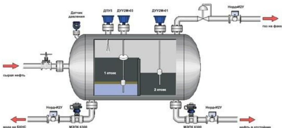
Рисунок 1 – Схема трехфазного нефтегазосепаратора
