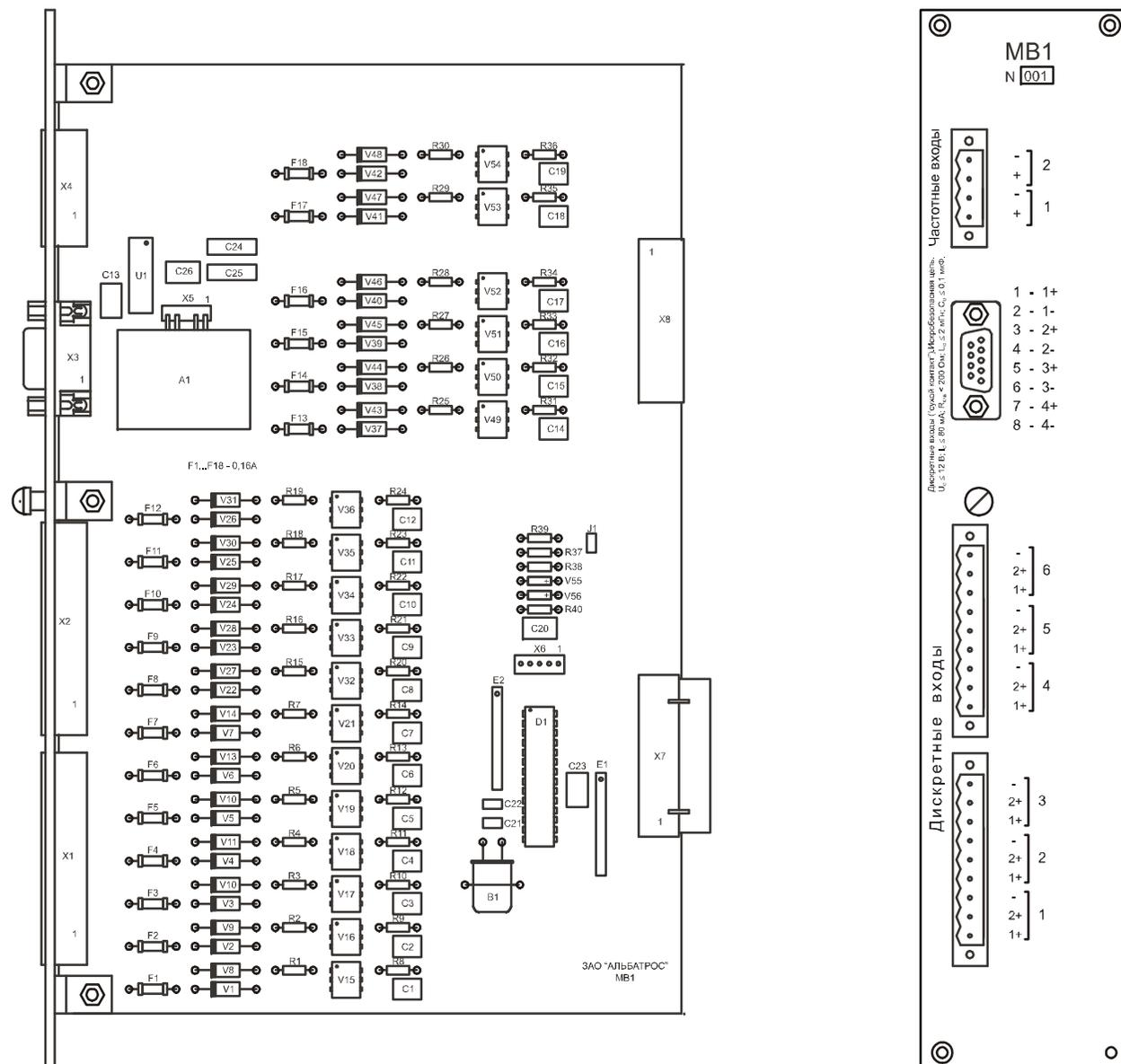
Рисунок Е.3 – Расположение элементов на плате модуля ввода МВ1
