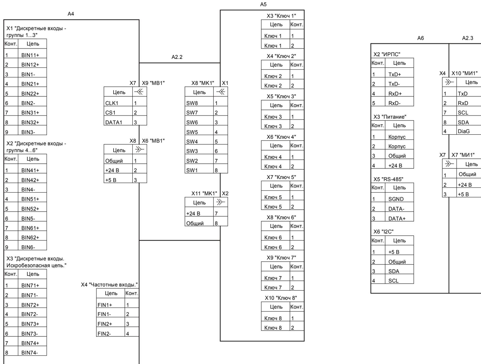
Рисунок В.2 – Принципиальная электрическая схема прибора (лист 2)
