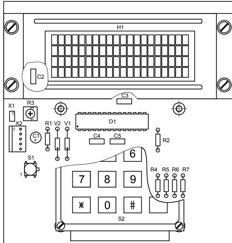
Рисунок J.2 – Расположение элементов на плате пульта
