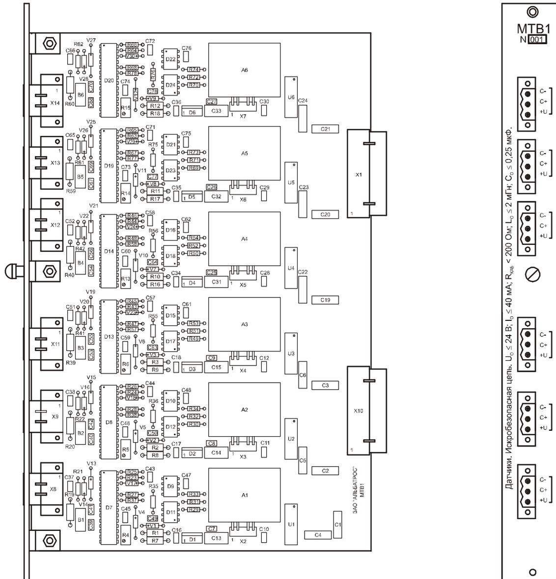
Рисунок D.5 – Расположение элементов на плате модуля токовых входов МТВ1
