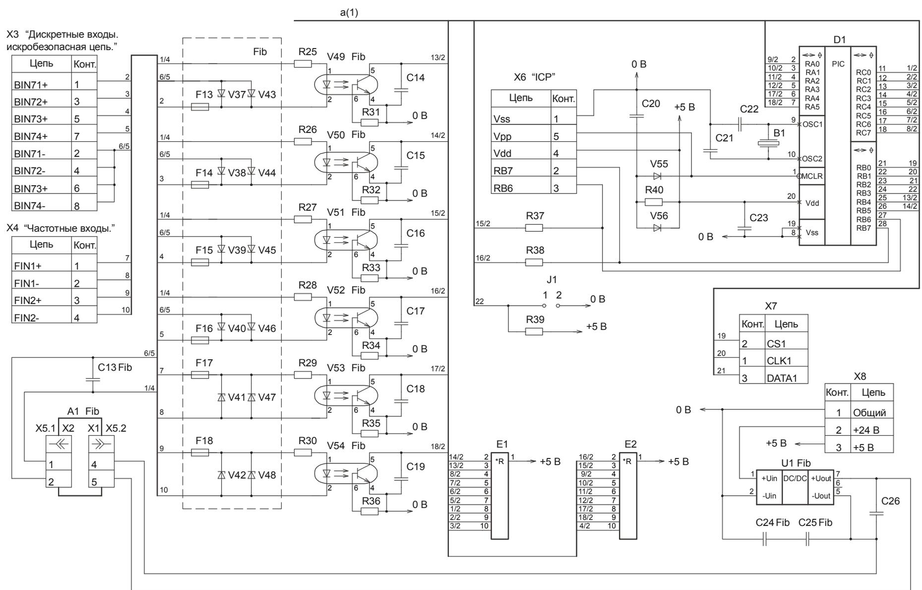
Рисунок Е.2 – Принципиальная электрическая схема модуля ввода MB1 (лист 2)
