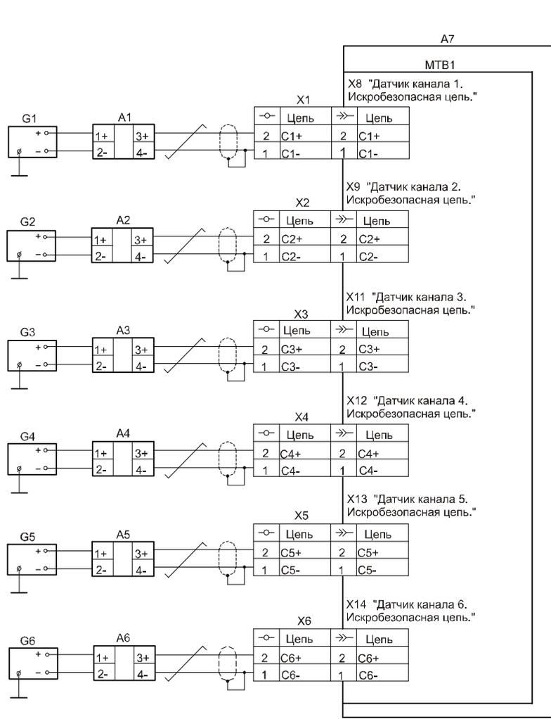
A1...A6 - датчик с токовым выходом 0...5 мА или 0...20 мА обычного исполнения;
