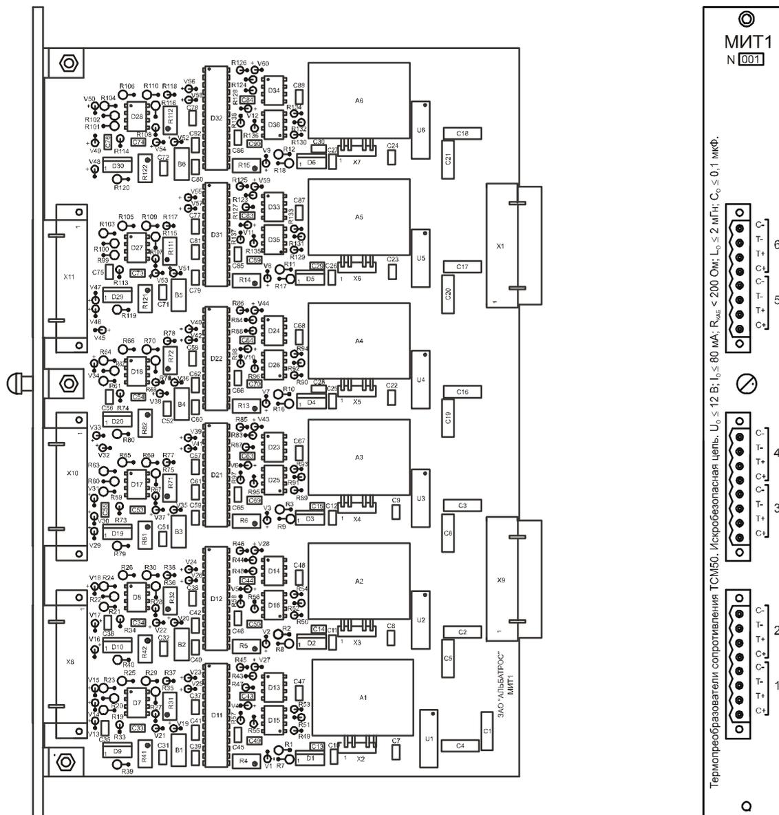
Рисунок С.5 – Расположение элементов на плате модуля интерфейса термометров МИТ1
