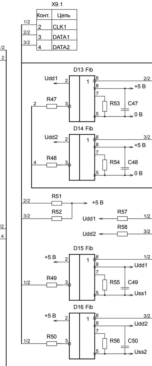
Рисунок С.2 – Принципиальная электрическая схема модуля интерфейса термометров МИТ1 (лист 2)
