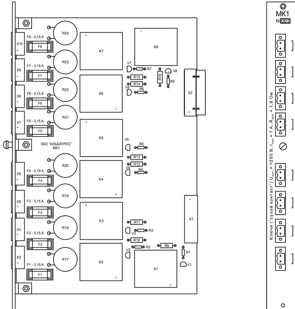
Рисунок F.2 – Расположение элементов на плате модуля ключей МК1
