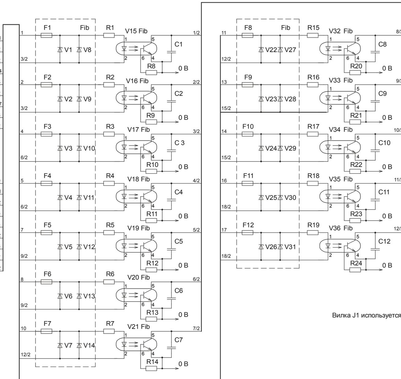
Рисунок Е.1 – Принципиальная электрическая схема модуля ввода МВ1 (лист 1)
