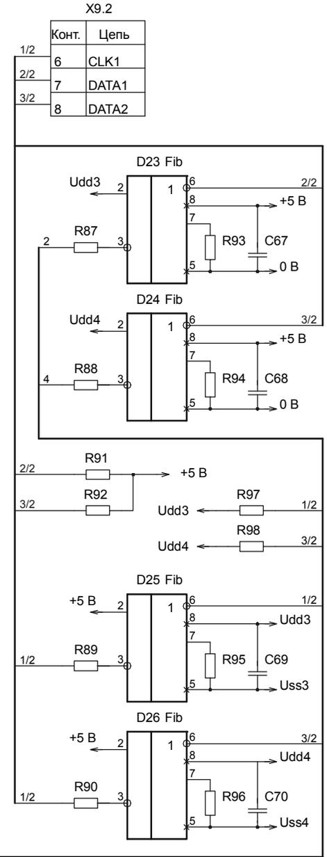
Рисунок С.3 – Принципиальная электрическая схема модуля интерфейса термометров МИТ1 (лист 3)
