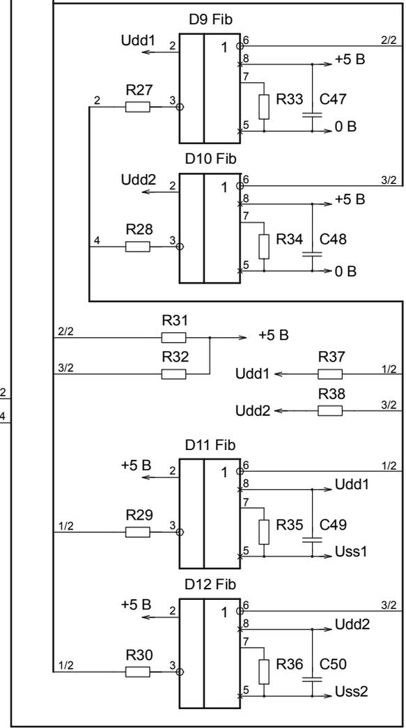
Рисунок D.2 – Принципиальная электрическая схема модуля токовых входов МТВ1 (лист 2)
