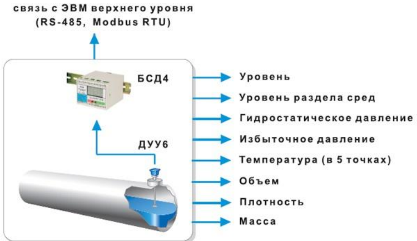
Рисунок 1 – Схема построения комплекса измерительного автономного для определения плотности и массы жидкости ДУУ4МА-(ДУУ6)
