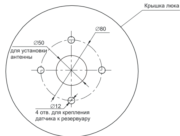
Рисунок 2 – Рекомендуемый вариант посадочного места датчика РДУ1-0(0А, 1, 1А, 2, 2А)
