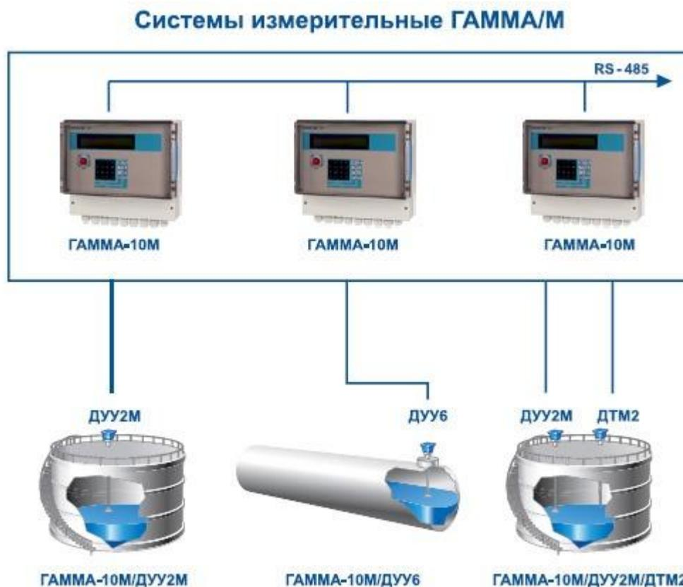
Рисунок 1 – Структурная схема систем
