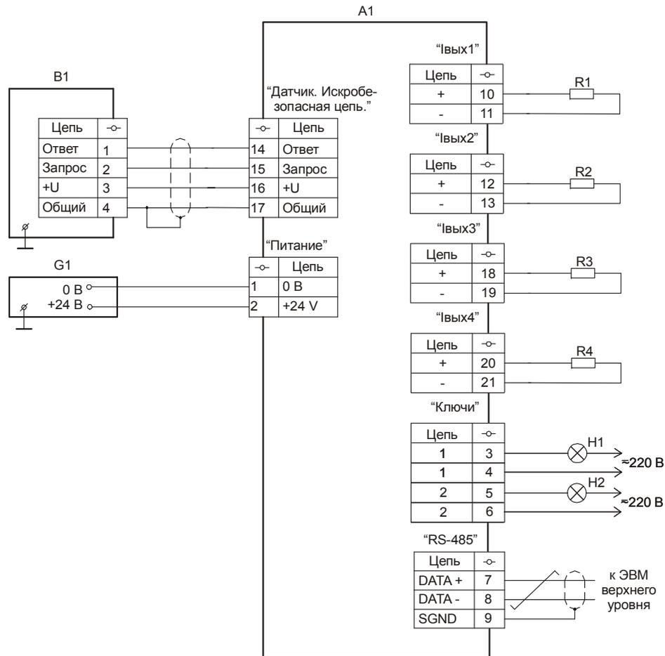
A1 - блок сопряжения с датчиком БСД4;
