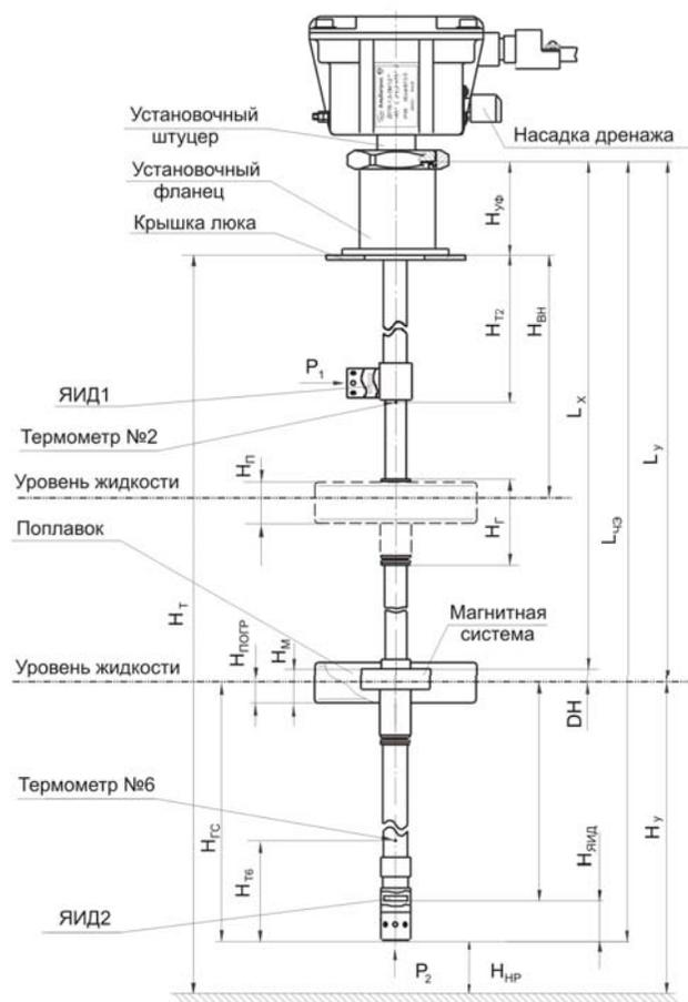
Рисунок 2 - Схема определения длины ЧЭ датчиков ДУУ6, ДУУ6-1
