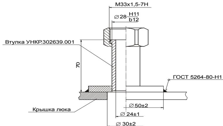
Рисунок 2 – Рекомендуемое посадочное место для установки датчиков
