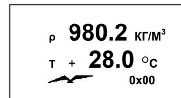
Рисунок 4 – Вид рабочего окна ЖКИ ячейки индикации ЯИ10
