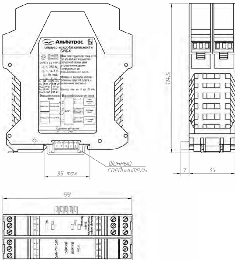
Рисунок 1 – Габаритные размеры приборов
