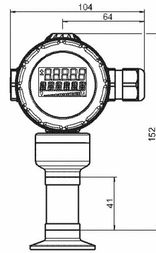
Преобразователь для температуры измеряемой среды до +200 °C
