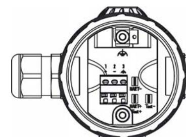
Рисунок 13 - Маркировка кабельного соединителя преобразователя с кабельным вводом
