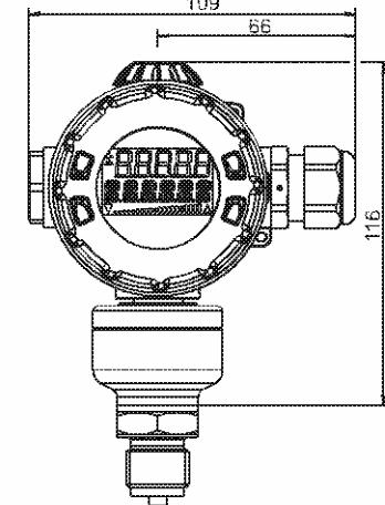
Тип 403025/0-0-3 (код 3, длинный корпус, прецизионное литье, с металлическим кабельным вводом)
