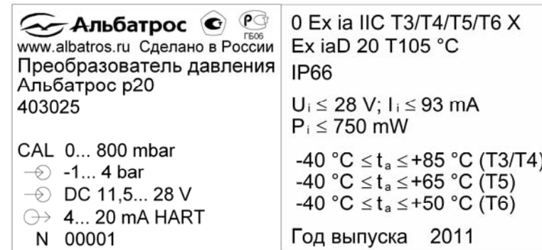
Рисунок 4 - Шильдик преобразователей взрывозащищенного исполнения
