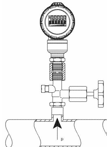
Рисунок 17 - Подключение преобразователей к системам измерения давления
