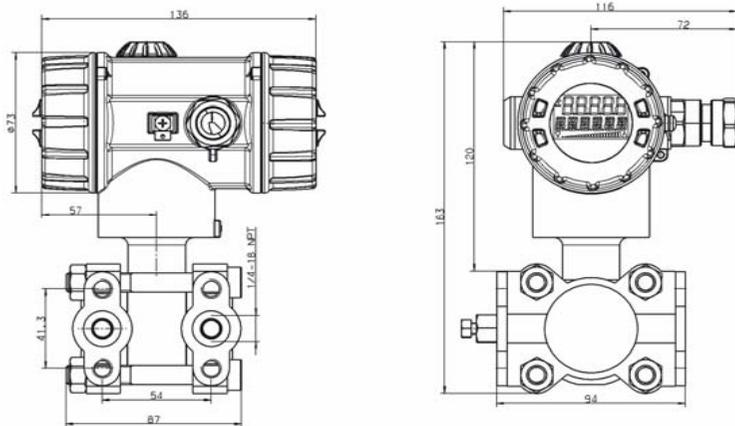
Рисунок 1 – Внешний вид и габаритные размеры преобразователей
