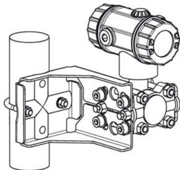
Рисунок 9 - Крепление к стене или трубе
