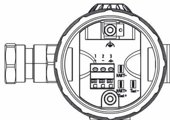
Рисунок 14 - Маркировка кабельного соединителя преобразователя с кабельным вводом
